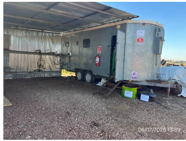
Foto 12.1-4, P06. Sector adaptado a taller mecánico, buenas condiciones de orden y limpieza, pero no hay contención para efluentes oleosos.
