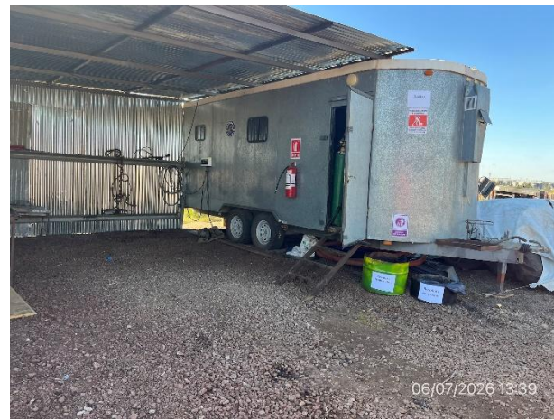
Foto 12.1-4, P03. Sector adaptado a taller mecánico, buenas condiciones de orden y limpieza, pero no hay contención para efluentes oleosos.
