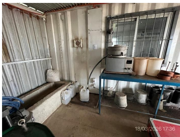
Foto 12.2-12, P03. Laboratorio de asfaltos. Extracción de asfalto hacia depósito con envallado correcto.
