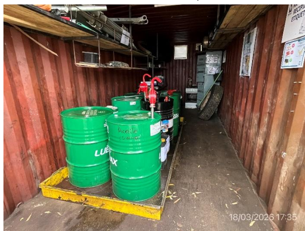
Foto 12.2-4, P03. Obrador, acopio de lubricantes en uso en local envallado y cerrado.
