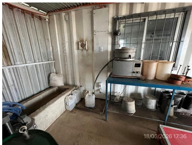
Foto 12.2-12, P03. Laboratorio de asfaltos. Extracción de asfalto. Hacia depósito con envallado correcto.
