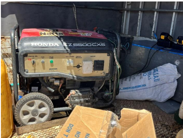
Foto 12.1-9. P06, generador alojado en bandeja estanca dentro del móvil de apoyo.
