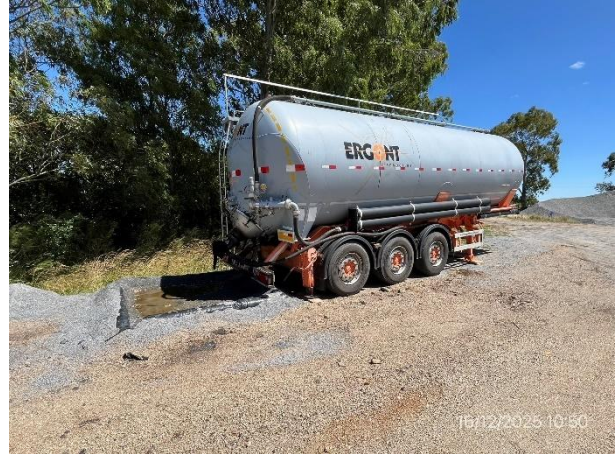
Foto 12.2-8, P03. Obrador, cisterna móvil de emulsión asfáltica con sector de descarga alojado en sector envallado.
