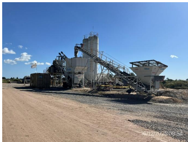
Foto 12.2-2, P03. Planta de hormigón, buenas condiciones de orden y limpieza.
