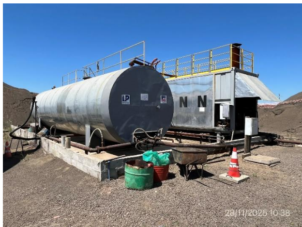
Foto 12.2-7, P04. Planta asfáltica, envallado perimetral correcto y está presente la infraestructura para el acopio temporal de residuos segregados en origen.
