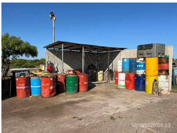
Foto 12.1-5, P05. Obrador, explanada de tarrinas vacías y recinto envallado y techado para acopio de lubricantes usados.
