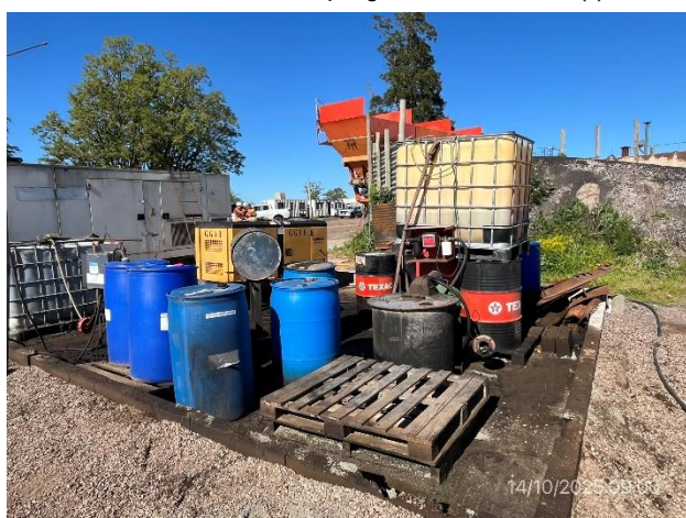
Foto 12.1-3, P04. Planta asfáltica, zona envallada para acopio de tarrinas con hidrocarburos.
