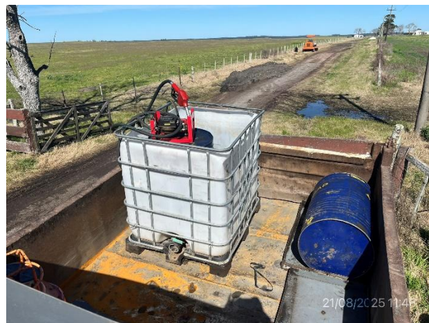
Foto 12.1-14, P07. Campamento provisorio, móvil de apoyo con surtidor de combustible con contención perimetral.
