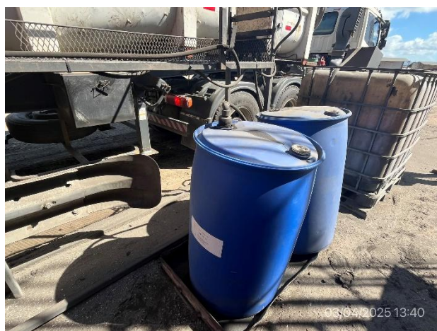
Foto 12.2-4. P03. Producto biodegradable para evitar adherencias de mezcla asfáltica durante el transporte
