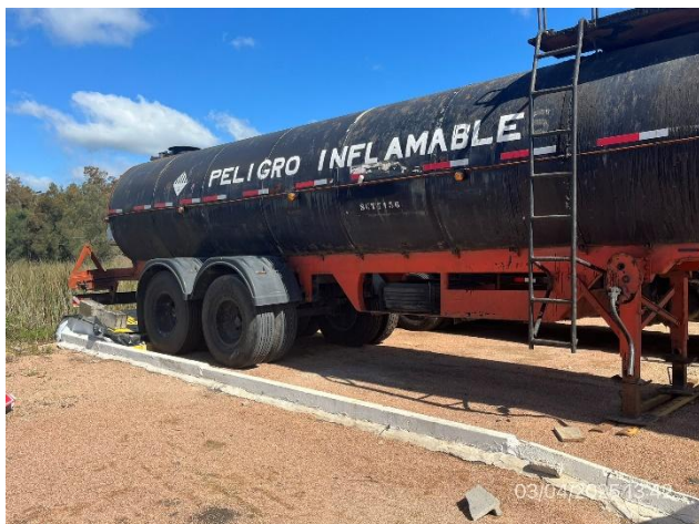
Foto 12.2-9. P03. Obrador. Cisterna de emulsión asfáltica alojada en sector con pavimento y envallado impermeable.
