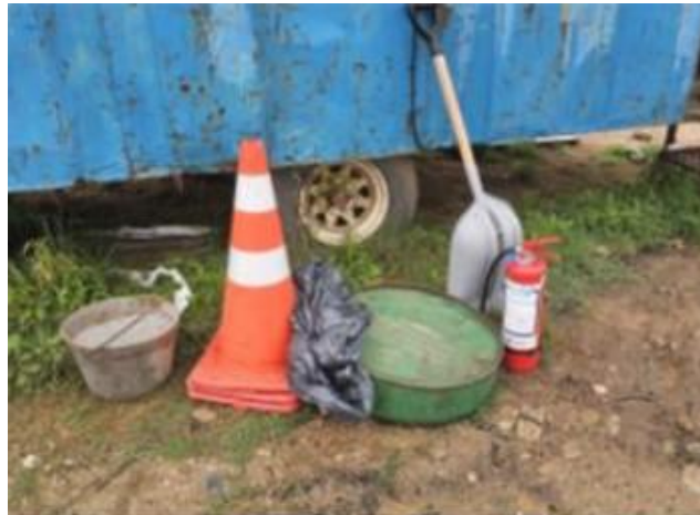
Foto 12.3-2. P04, Cantera de balasto. Se suministró el kit para la prevención de derrames. Fotografía remitida el 27/09/2024.
