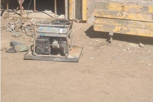
Foto 12.3-5. 10/04/2025. P13. Subcontratista Solstar, pasaje peatonal. Se agregó bandeja para prevención de derrames a generador eléctrico móvil.
