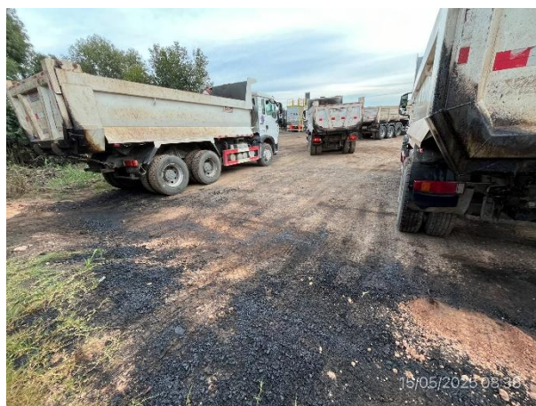
Foto 12.2-6, P03 el sector de estacionamiento y alije de casambas de mezcla asfáltica tiene derrames sin disponer. El piso no es impermeable y está en contrapendiente
