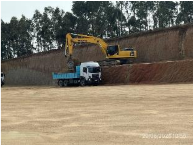
Foto 12.2-15, P06. Frente de explotación, maniobra de carga de camiones en proceso. No hay servicios de bienestar para los operarios permanentes.
