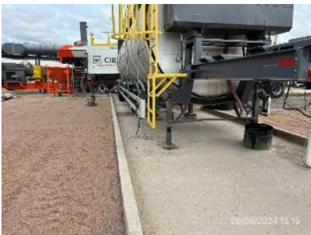
Foto 12.2-17. P03, Planta asfáltica. Cisterna de asfalto alojada en recinto con pavimento impermeable y envallado perimetral.
