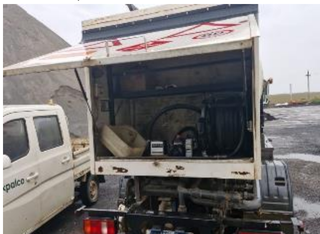
Foto 12.3-6, 30/08/2024, P03, Obrador Traxpalco. Se dotó al camión surtidor de bandejas estancas.
