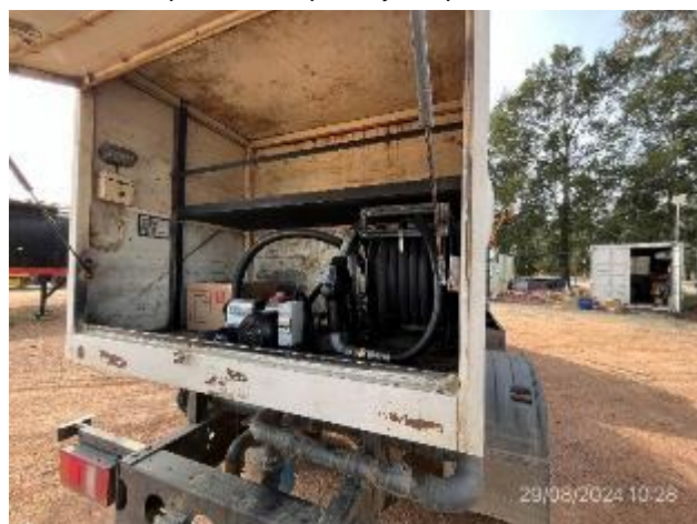
Foto 12.2-10, P03. Obrador, camión surtidor de combustible, no dispone de bandejas impermeables para las maniobras de abastecimiento.
