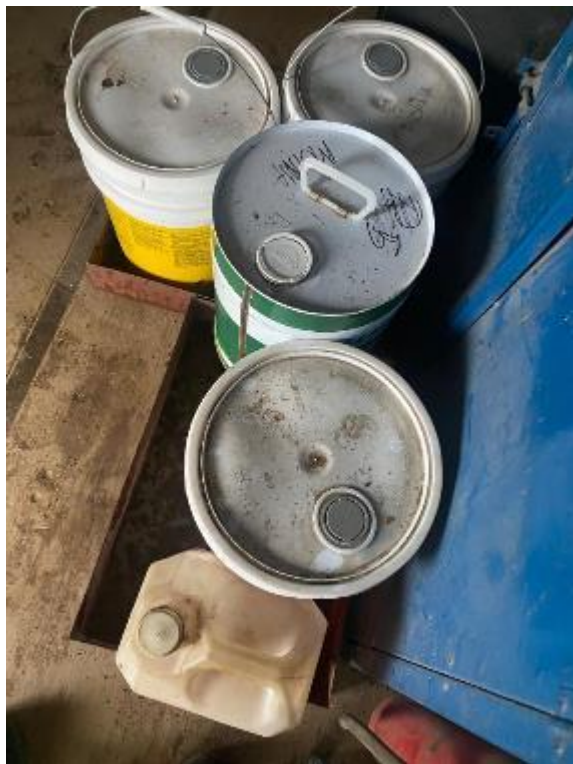
Foto 12.4-1. P03, Planta asfáltica, se incorporaron bandejas impermeables al pañol donde se ubicaron los bidones de lubricantes.
