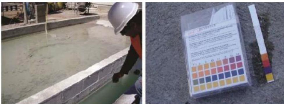
Figura 7-7: Ejemplo de medición de pH en efluentes de hormigón, utilizando cintas de pH.
