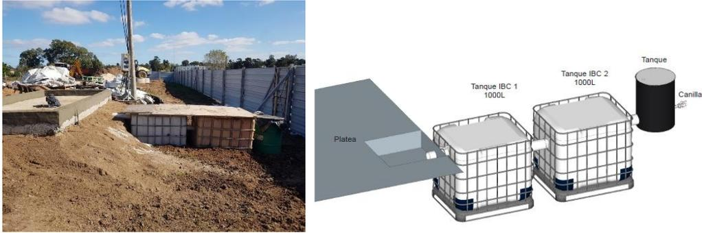
Figura 7-5: Imagen ilustrativa de sistema de tanques IBC.
