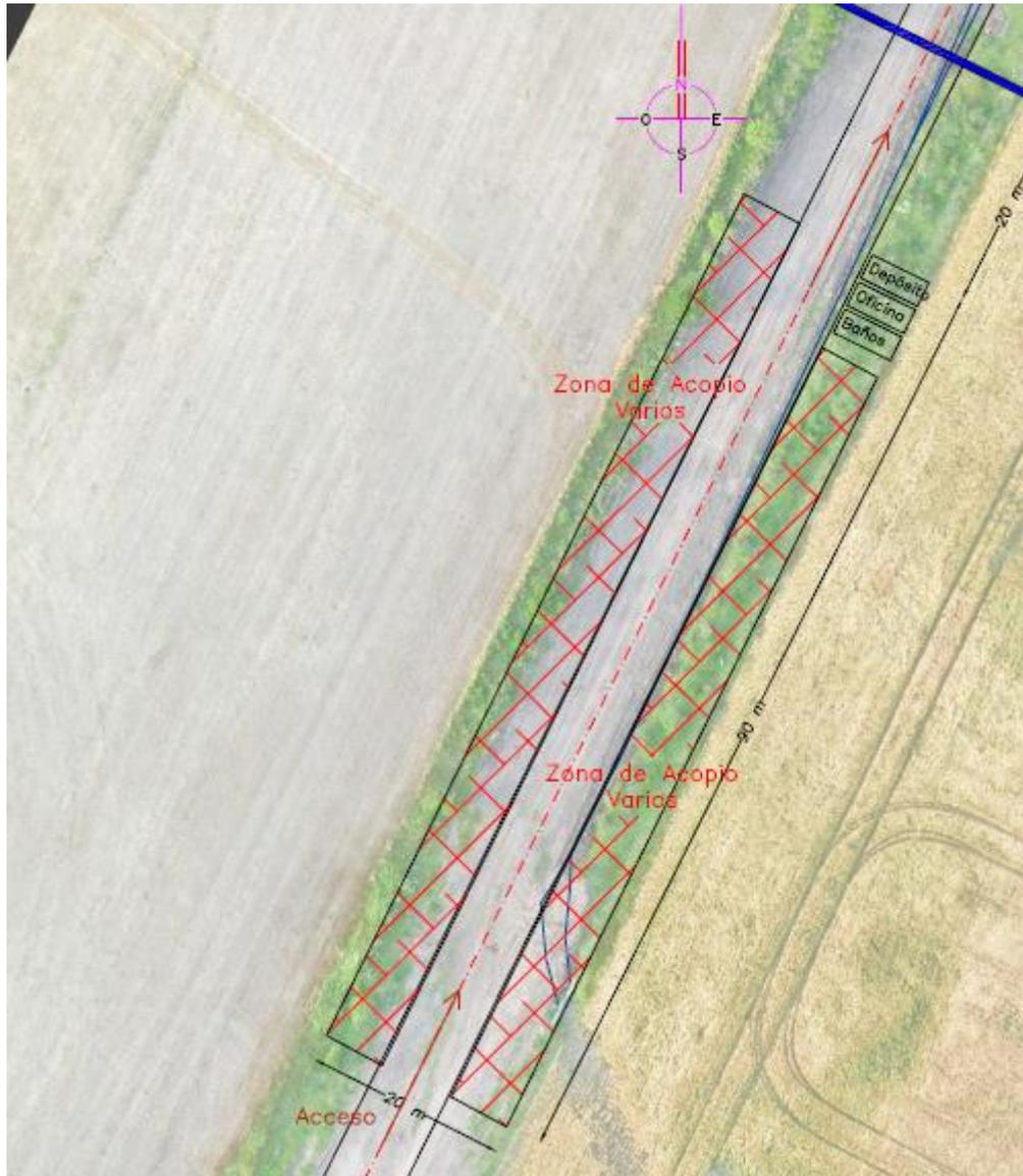
Figura 6-3: Esquema del obrador secundario, al Sur del río San Salvador.
