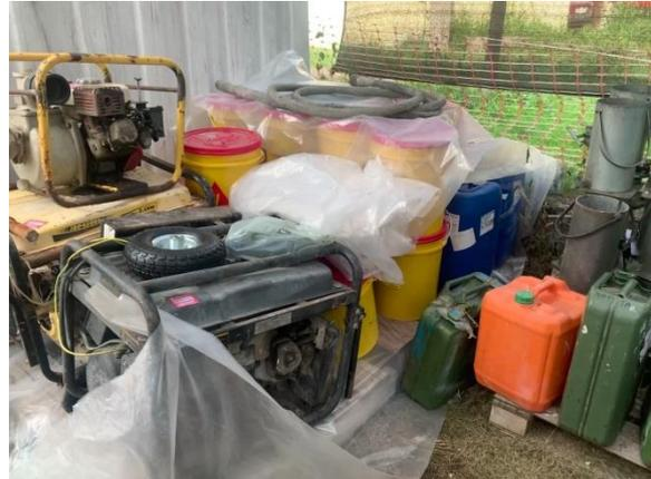
Ilustración 5 – P03, Obrador. Grupos electrógenos dispuestos sobre bandejas impermeables.
