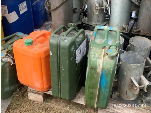
Ilustración 4 – P03, Obrador. Hidrocarburos en bidones mal dispuestos, sin contención inferior o perimetral
