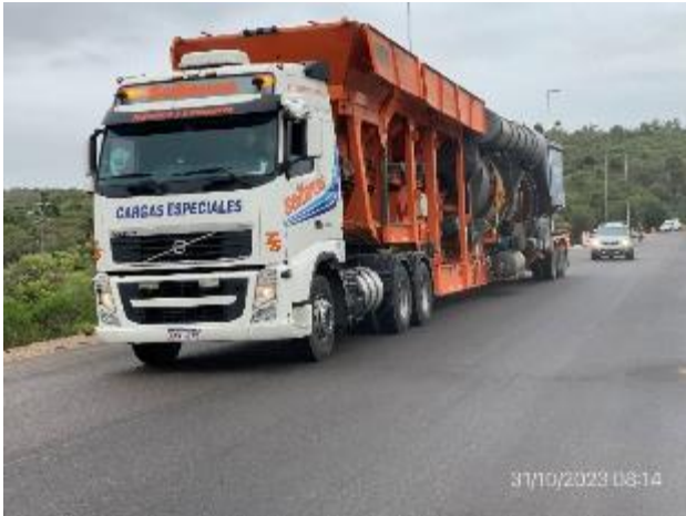
Foto 12.1-7. Planta asfáltica desmontada, en proceso de traslado
