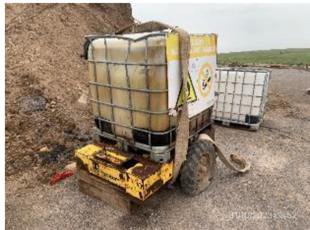
Foto 12.1-10, P06. Tanque móvil de combustible en condiciones inadecuadas, fuera de sector envallado y con pequeño derrame .
