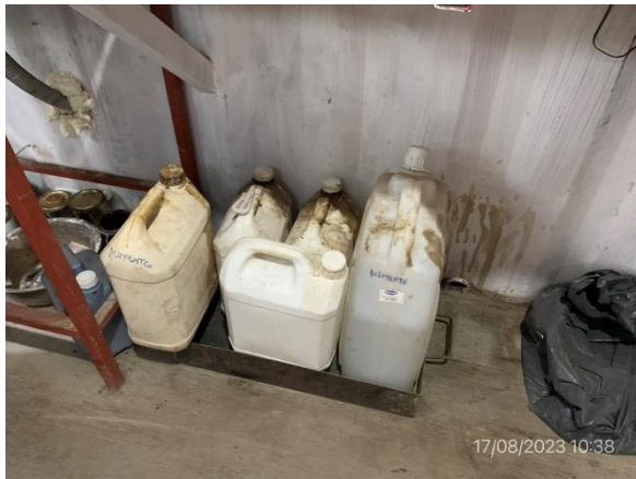
Foto 12.3-3 – Laboratorio de asfaltos. Receptáculos de percloroetileno sobre bandeja estanca.
