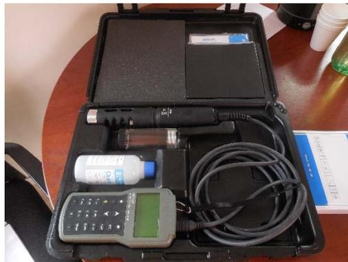
Figura 11-1 Equipo multiparámetro utilizado
