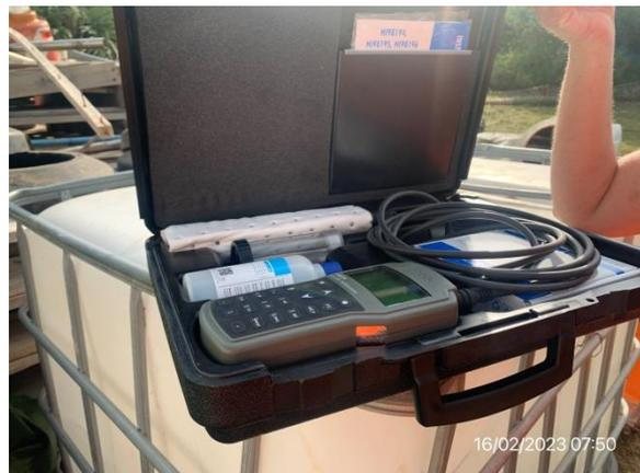
*Ilustración 7 – P03, Obrador. Equipo de medición multiparámetro de líquidos.*
