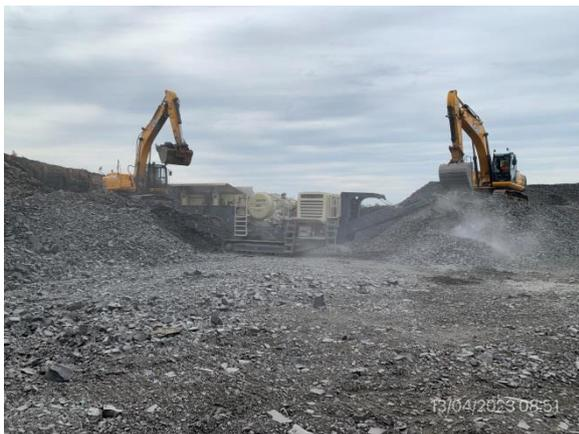
Ilustración 18 – P04, Cantera. Tren de trituración primario.
