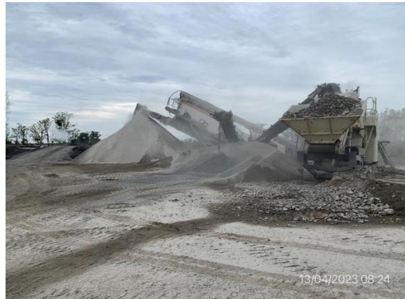
Ilustración 17 – P03, Planta Asfáltica. Tren de trituración secundario.
