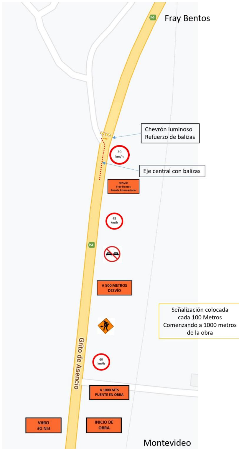
Figura 2 SEÑALIZACIÓN EN RUTA 2 Montevideo – Fray Bentos
