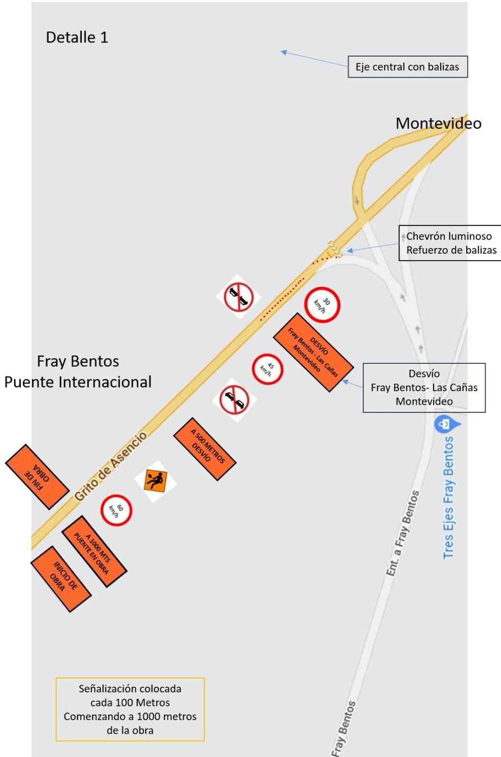
Figura 3 – SEÑALIZACIÓN EN DESVIÓ FRAY BENTOS - MONTEVIDEO
