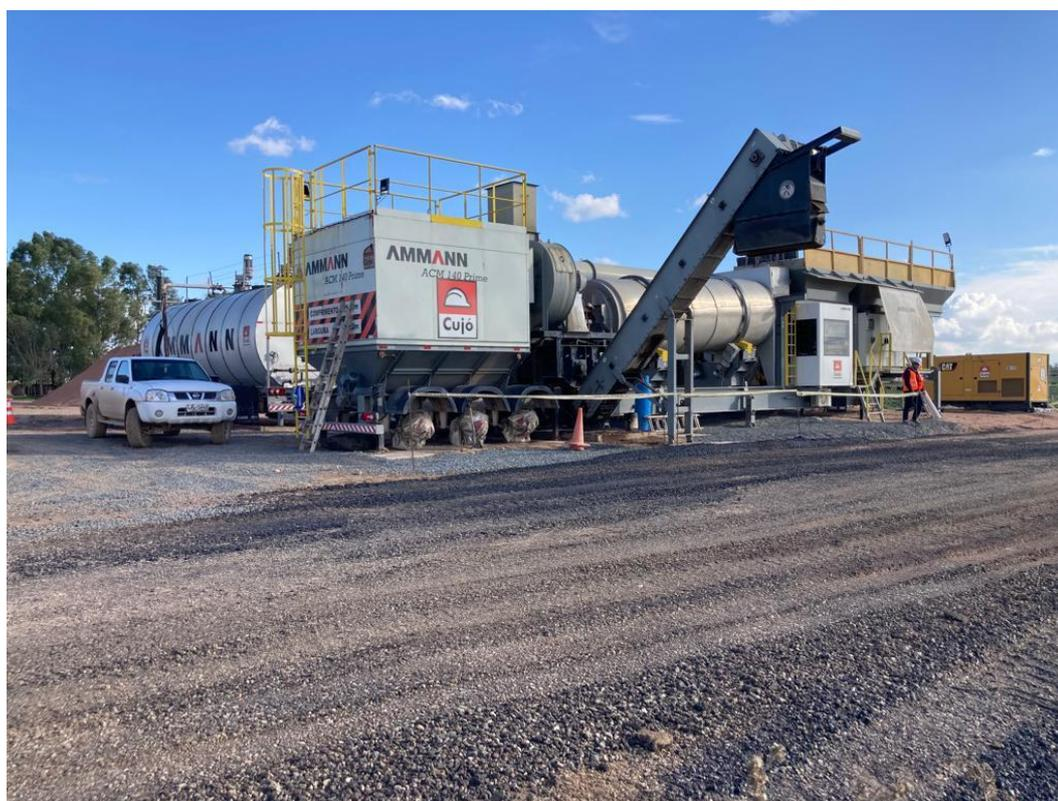
Imagen N°3: Planta Asfáltica
