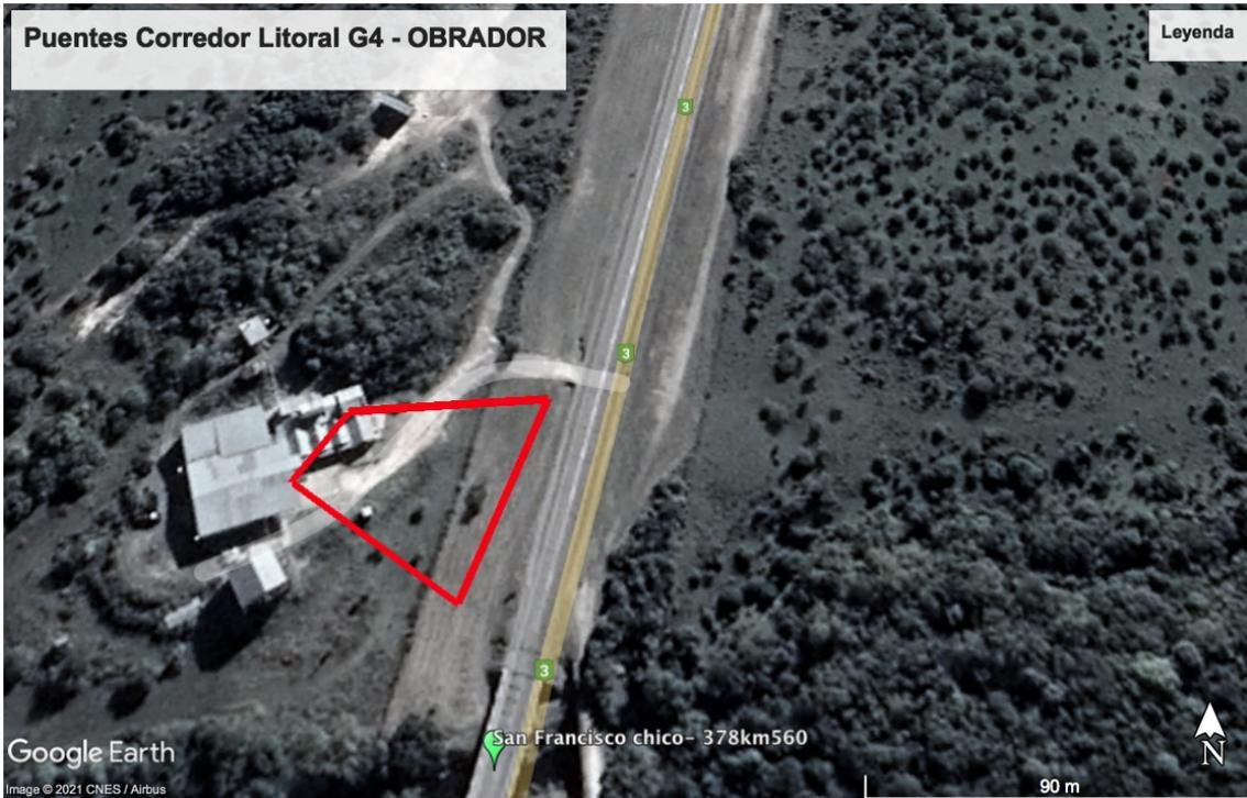
En el mismo se ubica una planta de hormigón, un galpón para depósito, área para elaboración de hierros, una zona para acopio de agregados y otra para el acopio de las viguetas prefabricadas que se producirán ahí, y un lavadero para los mixers de hormigón.
