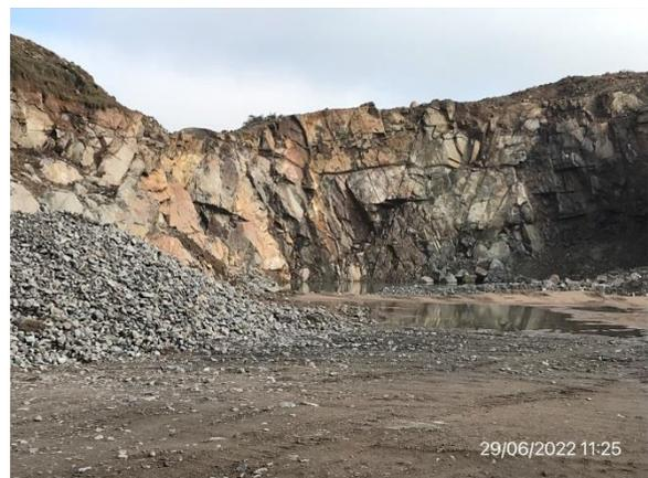
Ilustración 15 – P03, Cantera de piedra. Material de voladura listo para ser triturado.
