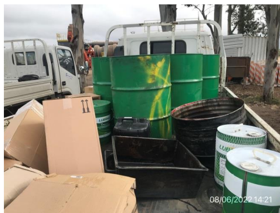
Ilustración 17 – P03, Obrador. Camión de mantenimiento mecánico liviano con bandejas para contención de derrames.
