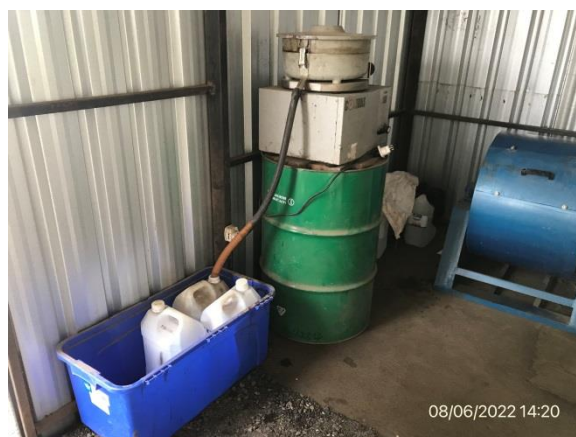
Ilustración 19 – P03, Obrador, laboratorio de suelos. Depósito de percloroetileno en recinto techado y con contención.
