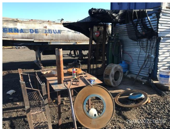
Ilustración 17 – P03, cantera de basalto. Sector de mecánica y soldadura en zona de trituración, sin infraestructura para gestión segregada de residuos.
