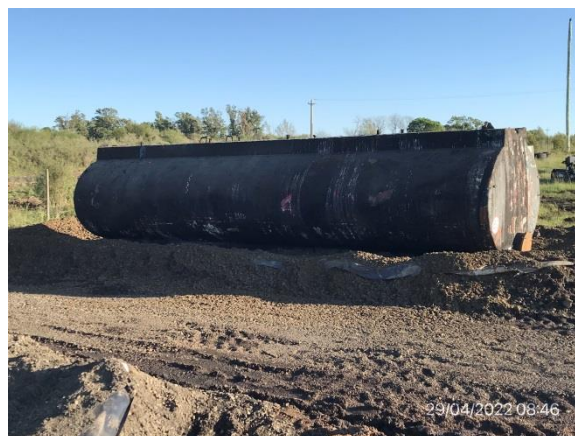
Ilustración 9 – P03, Obrador principal. Tanque de emulsión asfáltica en zona envallada con pavimento impermeable
