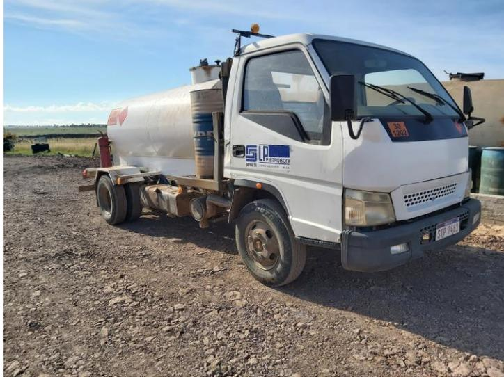
Esta se alimenta desde un tanque de almacenamiento dispuesto en el obrador central y recorre los diferentes frentes de obra llevando el combustible y lubricante necesario para su funcionamiento. Esta unidad está dotada de bandejas y elementos de contención para evitar posibles derrames en su tarea de reparto.
