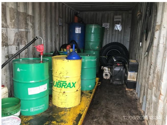
Ilustración 12 – P03. Obrador. Depósito cerrado de lubricantes con bandejas para trasiego.
